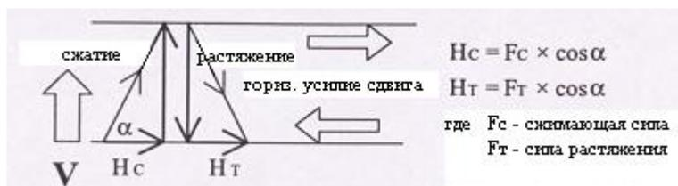
рис. 3.5.a модель усилия сдвига
