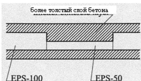
Рис 7.1.2.с Плита с более тонкой панелью
