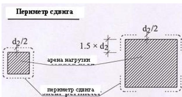
рис. 7.1.2.б Периметр сдвига
