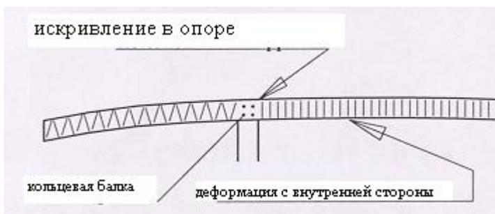
Рис. 8.4.а. Деформация объемной панели перекрытия от консольного момента.
