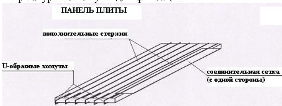
Рисунок 1.6 а. подготовка панелей плиты перед установкой
