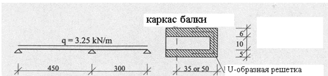
Рис. 8.4.3.в. Схема кромочной балки
