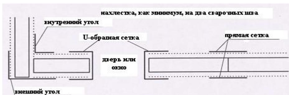
Рисунок 1.4 а. Распределение соединительной сетки
