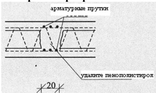
Рисунок 10.5.г. Поперечное ребро жесткости для промежутков свыше 6 метров.
